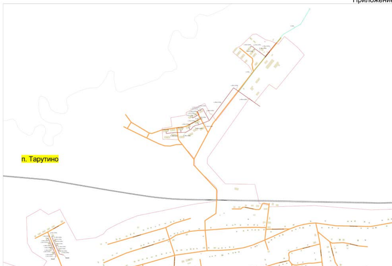
Рис.1. Схема водоотведения п. Тарутино
