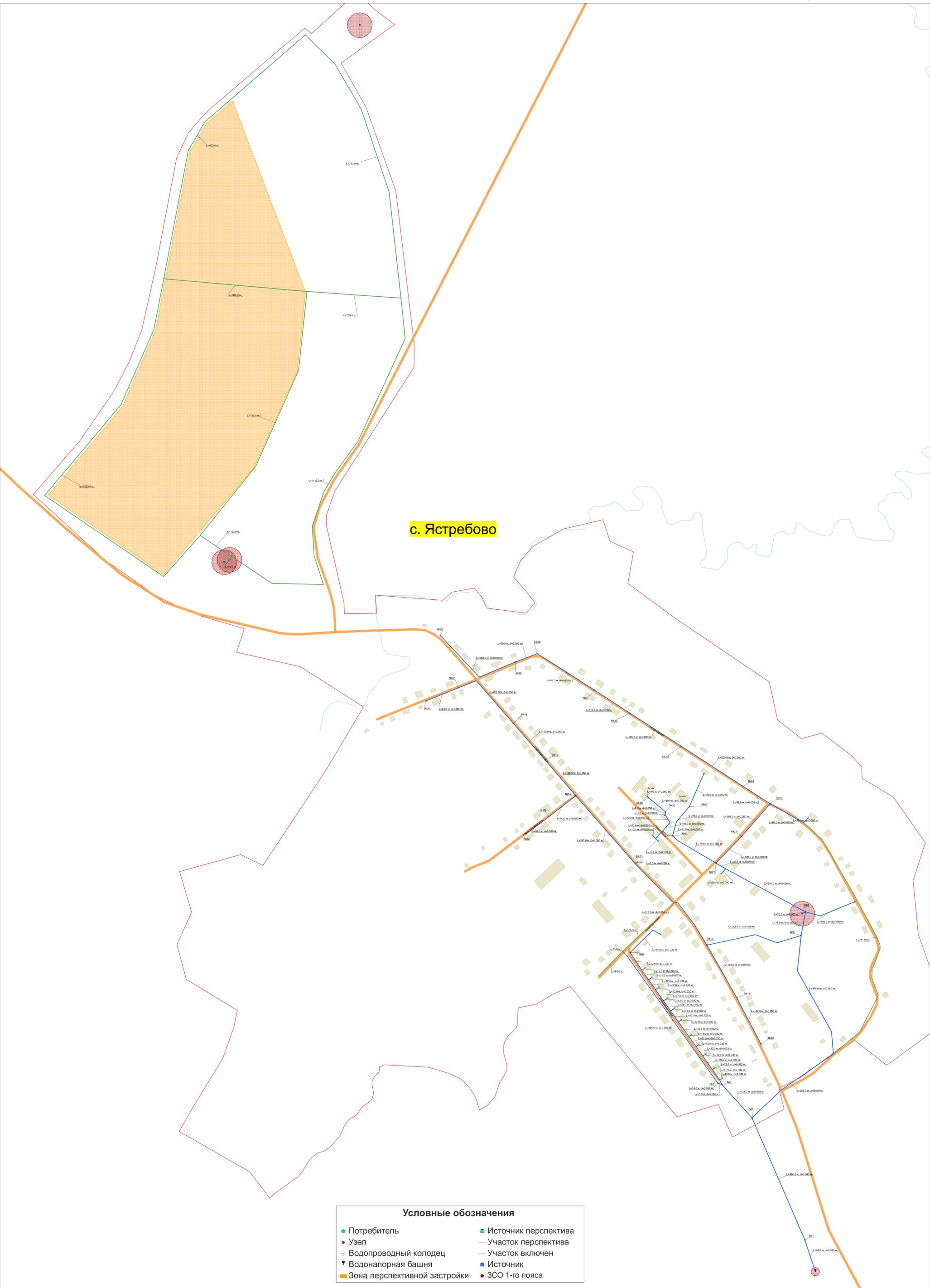
Рис. 1. Схема водоснабжения с. Ястребово
