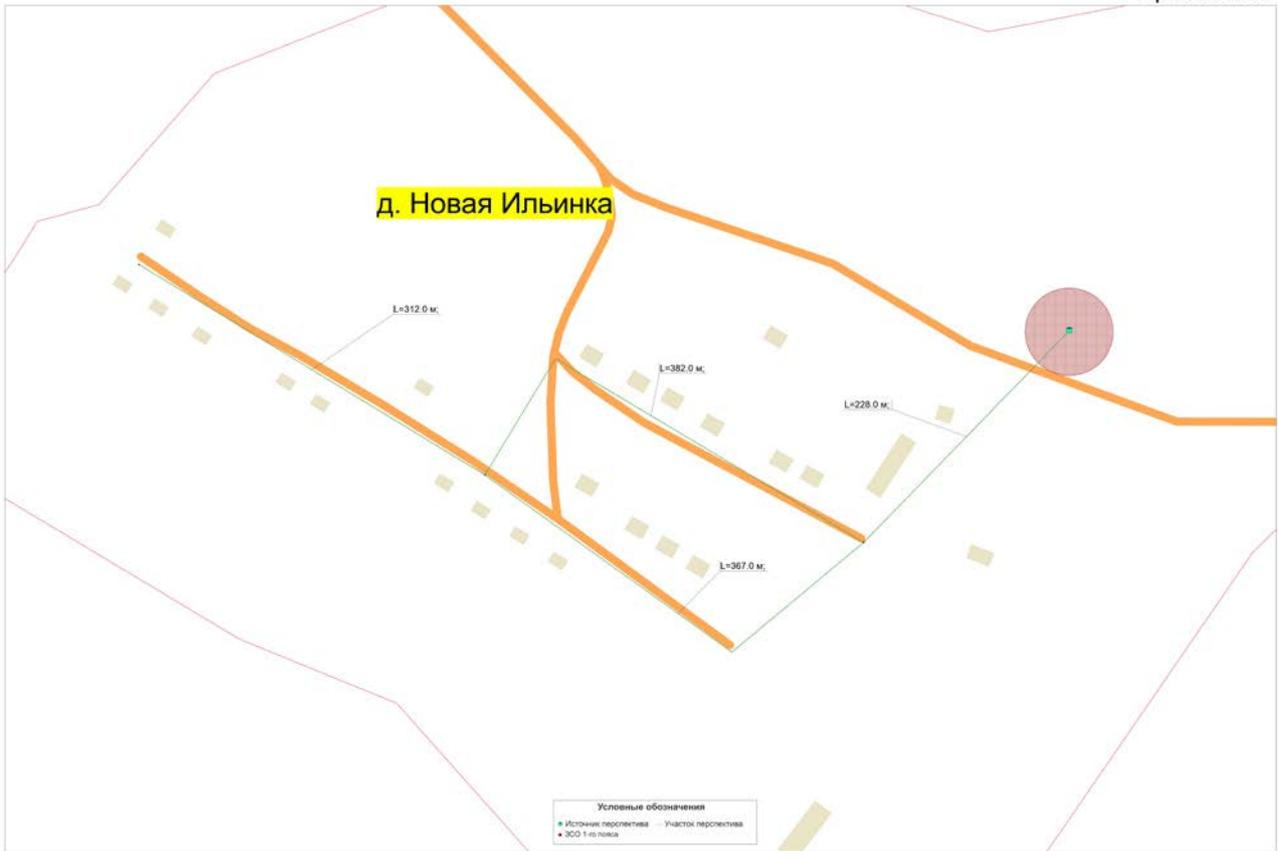
Рис. 6. Схема водоснабжения д. Новая Ильинка
