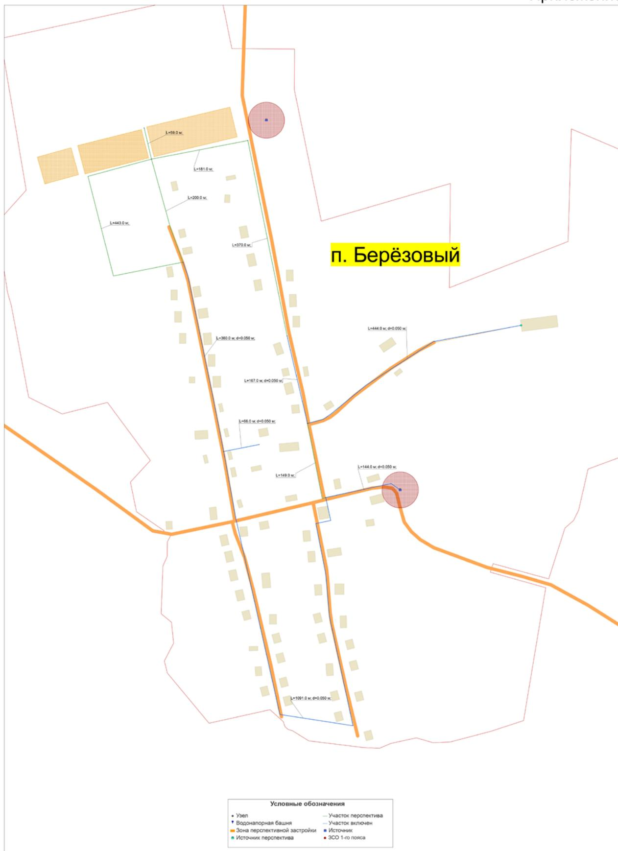
Рис. 3. Схема водоснабжения п. Берёзовый
