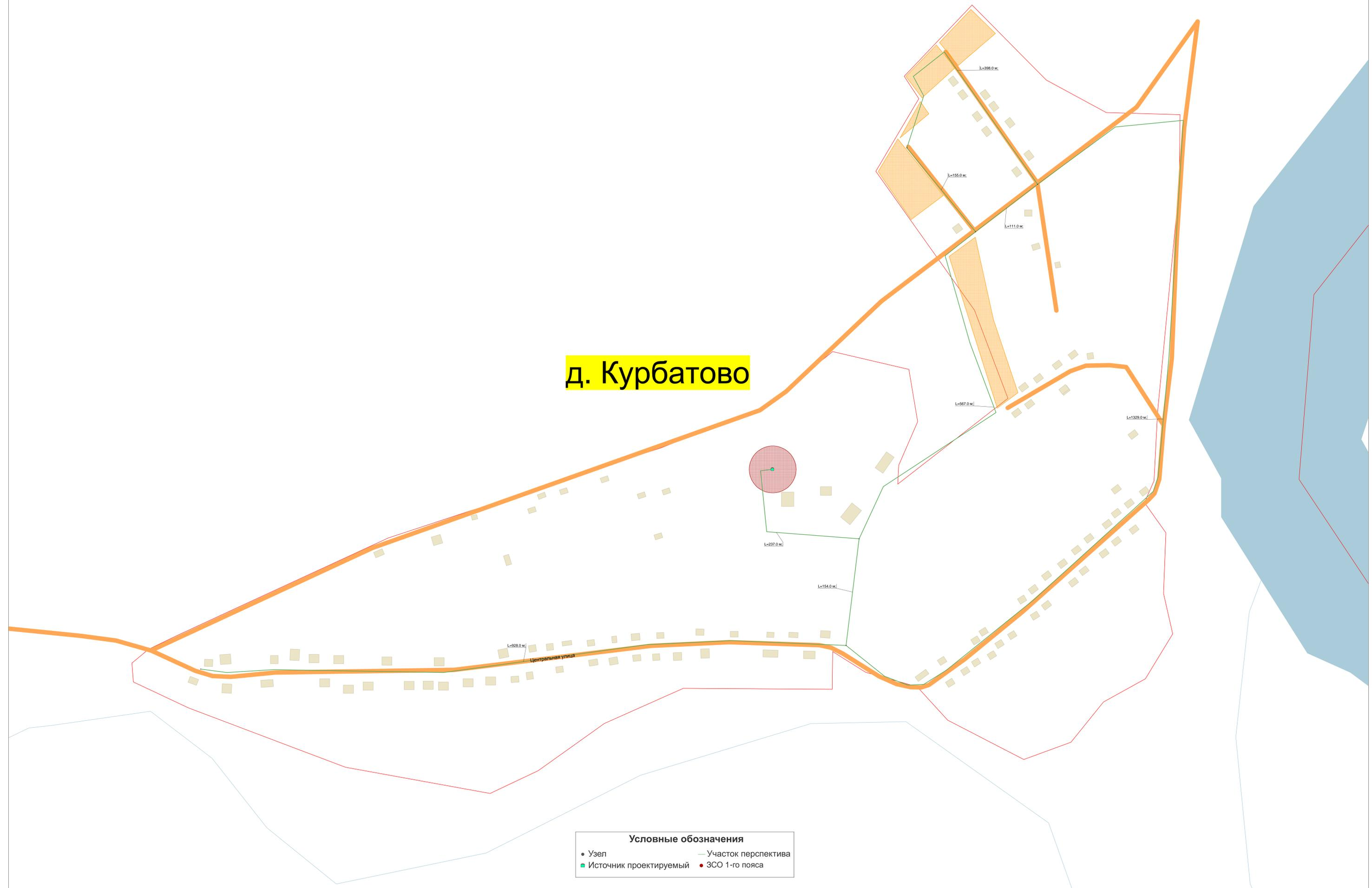
Рис.4. Схема водоснабжения д. Курбатово
